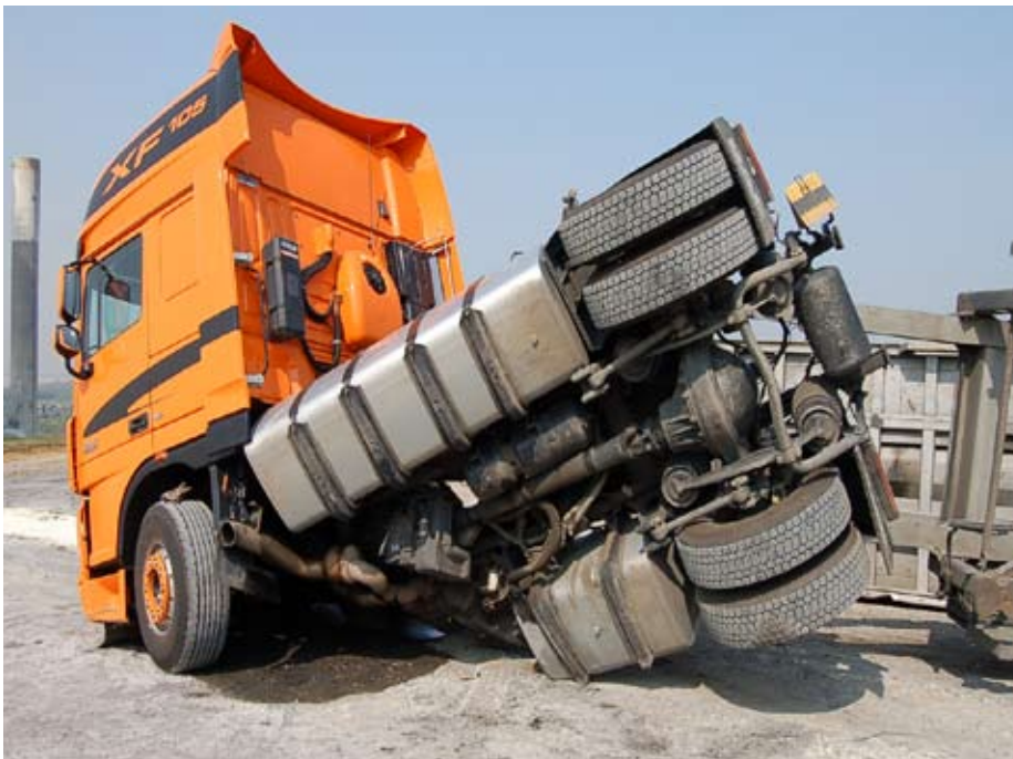
Auch dieses extrem verdrehte Chassis lässt sich in seinen Ursprungszustand zurückbiegen.
